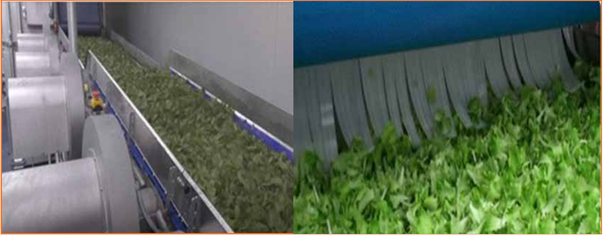
चित्र 3.2.5 पानी हटाने वाली बेल्ट और हवा सुखाने वाली सुरंग पर पहले से सुखाना
